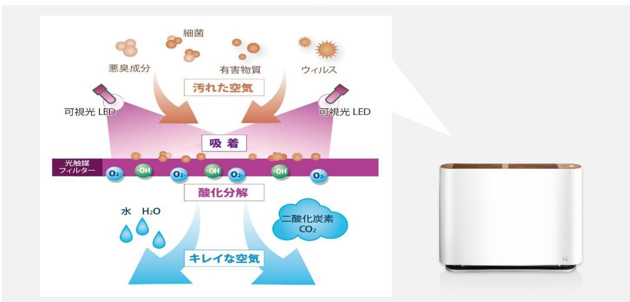
光触媒とLED光で、空気中のウイルスや菌、ニオイなどを分解し、顔周辺の空間を、除菌・消臭されたきれいな空気へと浄化します。
